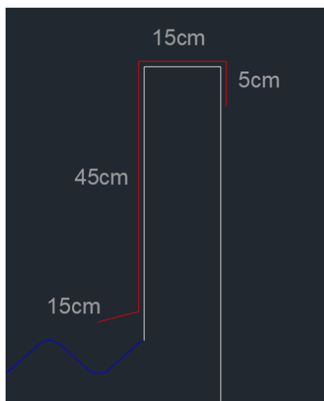
Detalhamento das algerosas e/ou capas.
